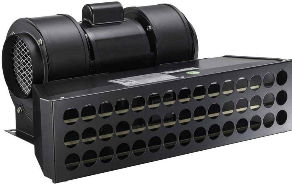
JH6001A 离子风鼓可产生大量的带有正负电荷的气流，可以将物体上所带的电荷中和掉。当物体表面所带电荷为负电荷时，它会吸收气流中的正电荷，当物体表面所带电荷为正电荷时，它会吸收气流中的负电荷，从而使物体表面上的静电被中和，达到消除静电的目的。
